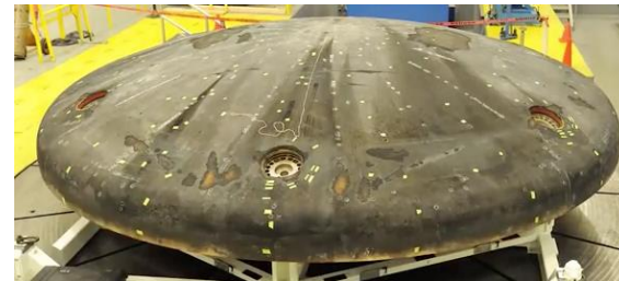
EFT-1 Orion heat shield 5 meter diameter
