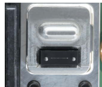
Plan serré du connecteur de fond de panier 4+4 voies SpaceCONEX28 .
