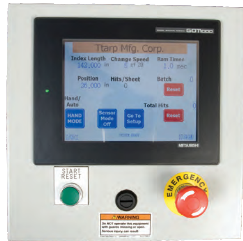
Interfaz de pantalla táctil (se monta en la consola móvil) permite una configuración sencilla, fácil ajuste durante la operación y almacenamiento de procedimientos.
