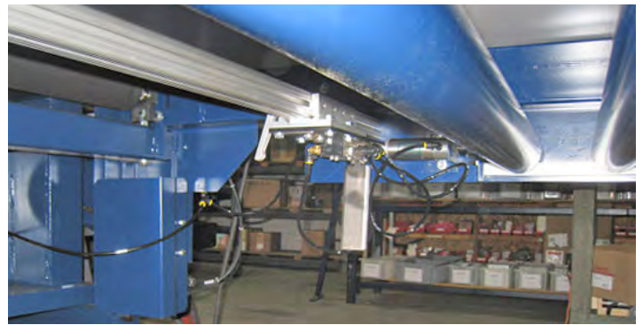
El seguimiento automático de la correa presenta un nuevo diseño de servicio pesado que es menos susceptible a la humedad y las fluctuaciones de presión en el aire comprimido. Fácil de usar y prolonga la vida útil del cinturón.
