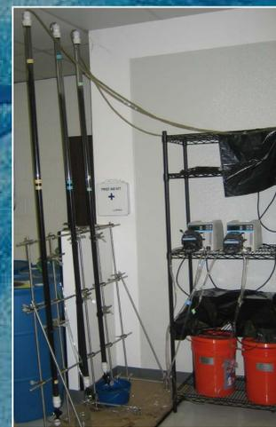
SMI<sup>®</sup>III<sup>®</sup> Column Tests
