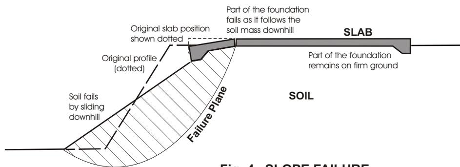
Fig. 4 SLOPE FAILURE
