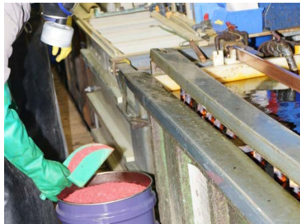
La fotografia mostra la regolazione del bagno con triossido di cromo..
