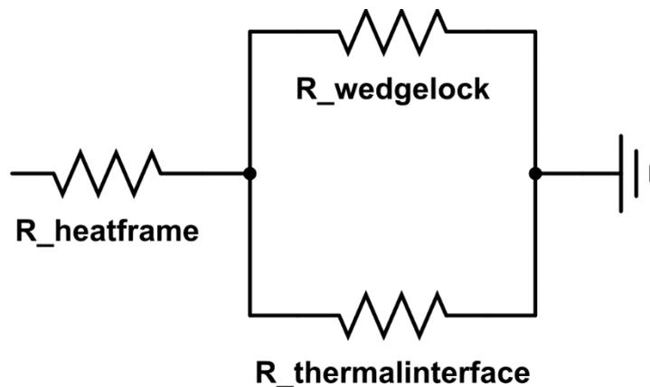
FIGURE 4 - THERMAL RESISTANCE NETWORK OF WEDGELock JOINT
