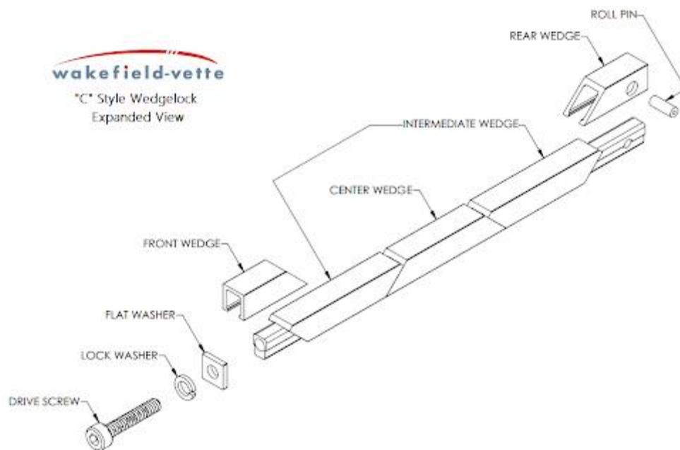
FIGURE 1 - EXPANDED VIEW OF A TYPICAL 5 WEDGE WEDGELOCK [1]
