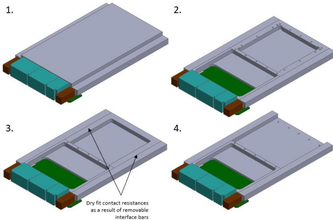
FIGURE 9 - GRAPHICAL REPRESENTATION OF HEATSINK CONFIGURATIONS UNDER TEST
